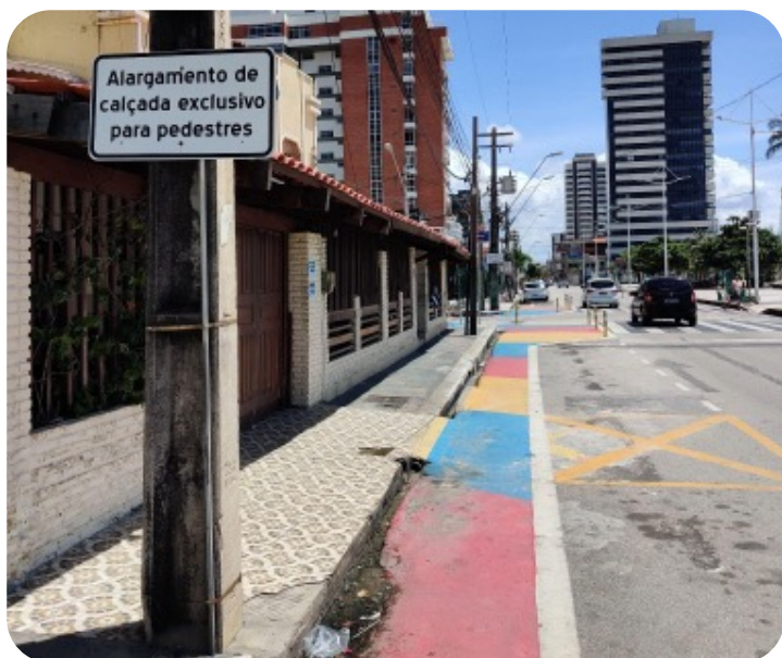
FIGURA 2 • Alargamento de calçada sobre leito carroçável na cidade de Fortaleza-CE
